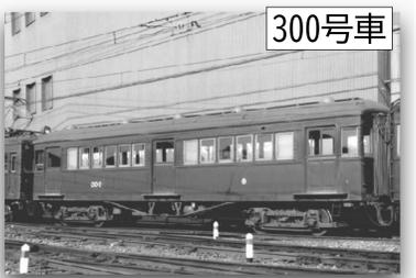
全鋼製車両として知られる存在ですが、少し古めかしい外観で、本紙2022年2月号に写真を載せています。一方、それまで宝塚線で使われていた車両の一部は神戸線へ転属して今津線で使われるようになりましたが、残った小型車には、プラットホームと車両との間隔が広がって危険なため、各乗降口にステップが設けられました。写真の300号車にも扉の下にステップが見えます。
